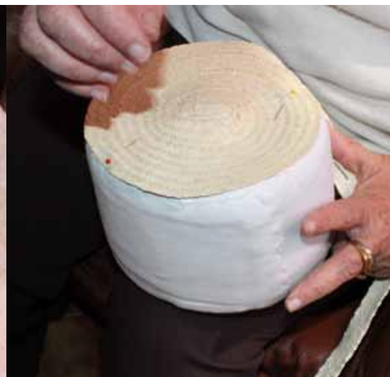
O topo do chapéu é colocado num molde. A trança é cosida com uma agulha comprida de madeira The top of the hat is fixed onto a wooden mold. The braid is stitched with a long wood needle
