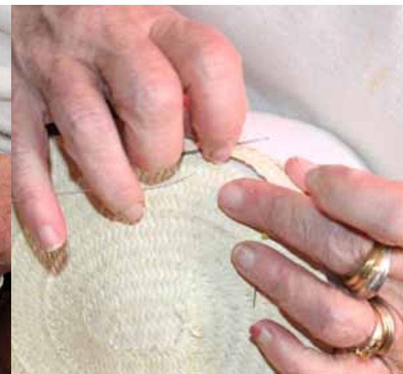
O topo do chapéu é colocado num molde. A trança é cosida com uma agulha comprida de madeira The top of the hat is fixed onto a wooden mold. The braid is stitched with a long wood needle
