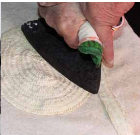
O palmito é engomado geralmente com um ferro de placa The flat iron is the most used for ironing the palmito of the hat
